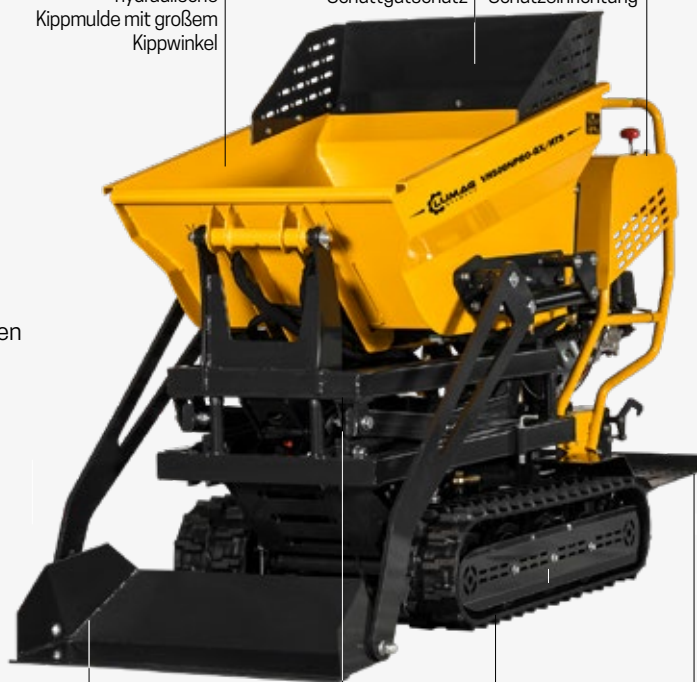
Hydr. Selbstladeschaufel max. Zuladung 150 kg
