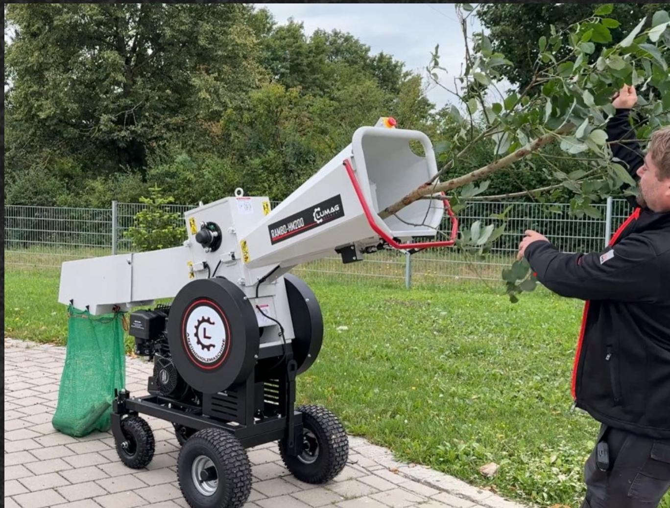
Fahrwerk mit Feststellbremse und Zugdeichsel
